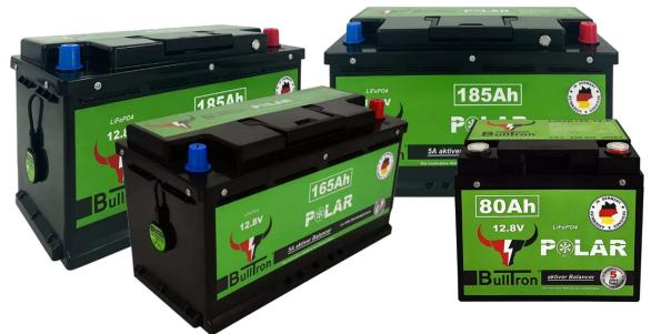
Die «**POLAR**» Versionen verfügen über eine integrierte Zellheizung und sind somit bei **Temperaturen bis -30°C zu 100% einsatzfähig**. Hierbei erfolgt die Aufheizung der Zellen nur mit Energie aus externen Quellen (Alternator, Solarmodule, Landstrom etc.). Die Batterie verbraucht nie die bereits in der Batterie eingespeicherte Energie für die Aufheizung.
