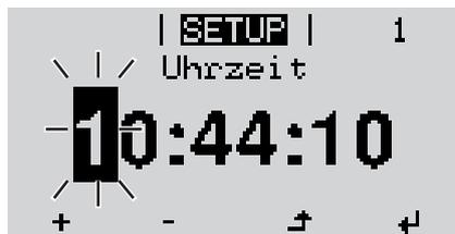
Die Uhrzeit wird angezeigt. (HH:MM:SS, 24-Stunden-Anzeige), die Zehner-Stelle für die Stunde blinkt.
