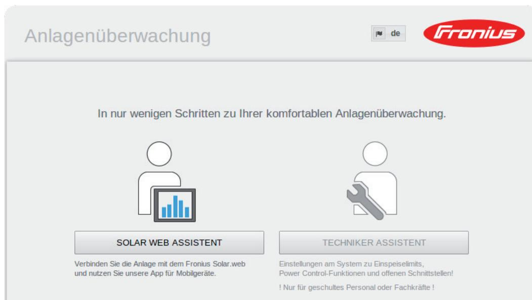
Wird der Techniker Assistent ausgeführt, unbedingt das vergebene Service-Passwort notieren. Dieses Service-Passwort ist für die Einstellung der Menüpunkte Anlagenübersicht, EVU-Editor und erweiterte Batterieeinstellungen erforderlich.
