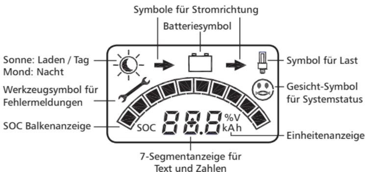
Die Anzeigefenster werden automatisch der Reihe nach angezeigt. Dieser rollierende Wechsel kann über die linke Taste gestoppt und wieder gestartet werden. Die Balkenanzeige stellt dabei in jedem Fenster den aktuellen Ladezustand (SOC = state of charge) der Batterie dar. Ist der Regler auf Spannungssteuerung eingestellt, erscheint die SOC Balkenanzeige nicht und der prozentuale SOC Wert wird durch die Batteriespannung ersetzt!
