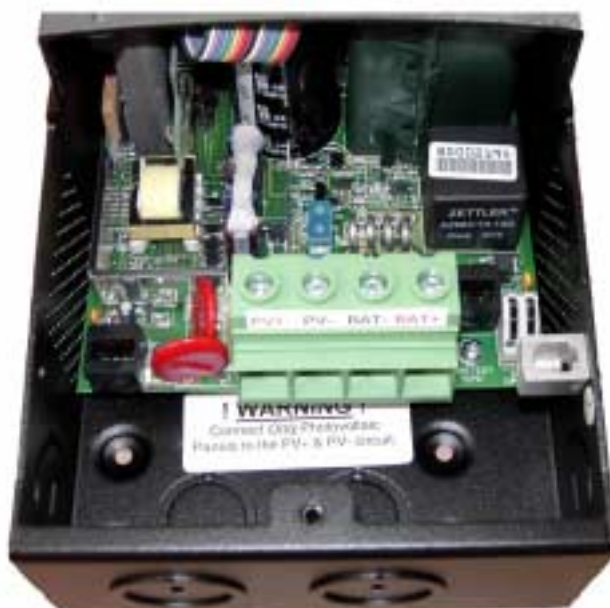
Bild 3 - Anschlussfeld und Anschlussklemmen des MX60
