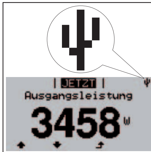
USB-Symbol am Wechselrichter-Display, z.B. im Anzeigemodus 'JETZT'
