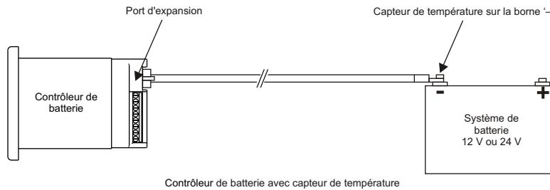
Contrôleur de batterie avec capteur de température
