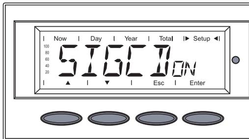
Der 'Signal Card Test' wird gestartet, am Display erscheint 'SIGCD ON'.
