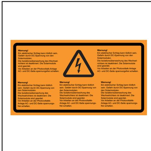
Sicherheitsaufkleber für Solarmodul-Erdung
