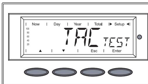
'TAC TEST' wird angezeigt, das AC-Relais schaltet aus und die AC-Verbindung zum Wechselrichter wird unterbrochen (keine Netzeinspeisung).
